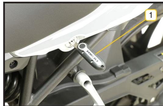
Levante la parte delantera del asiento del pasajero y empujelo hacia adelante para retirarlo.
